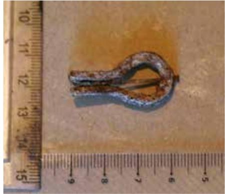
fig. 67 [118] の「裏面」(振動弁が直角に曲げられている側と反対側)。振動弁が杵にカシメて取り付けられている様子がわかる。2017. 6. 11 筆者撮影
